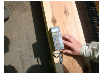
含水率測定。乾燥が完了したかどうか含水率計にて測定する
